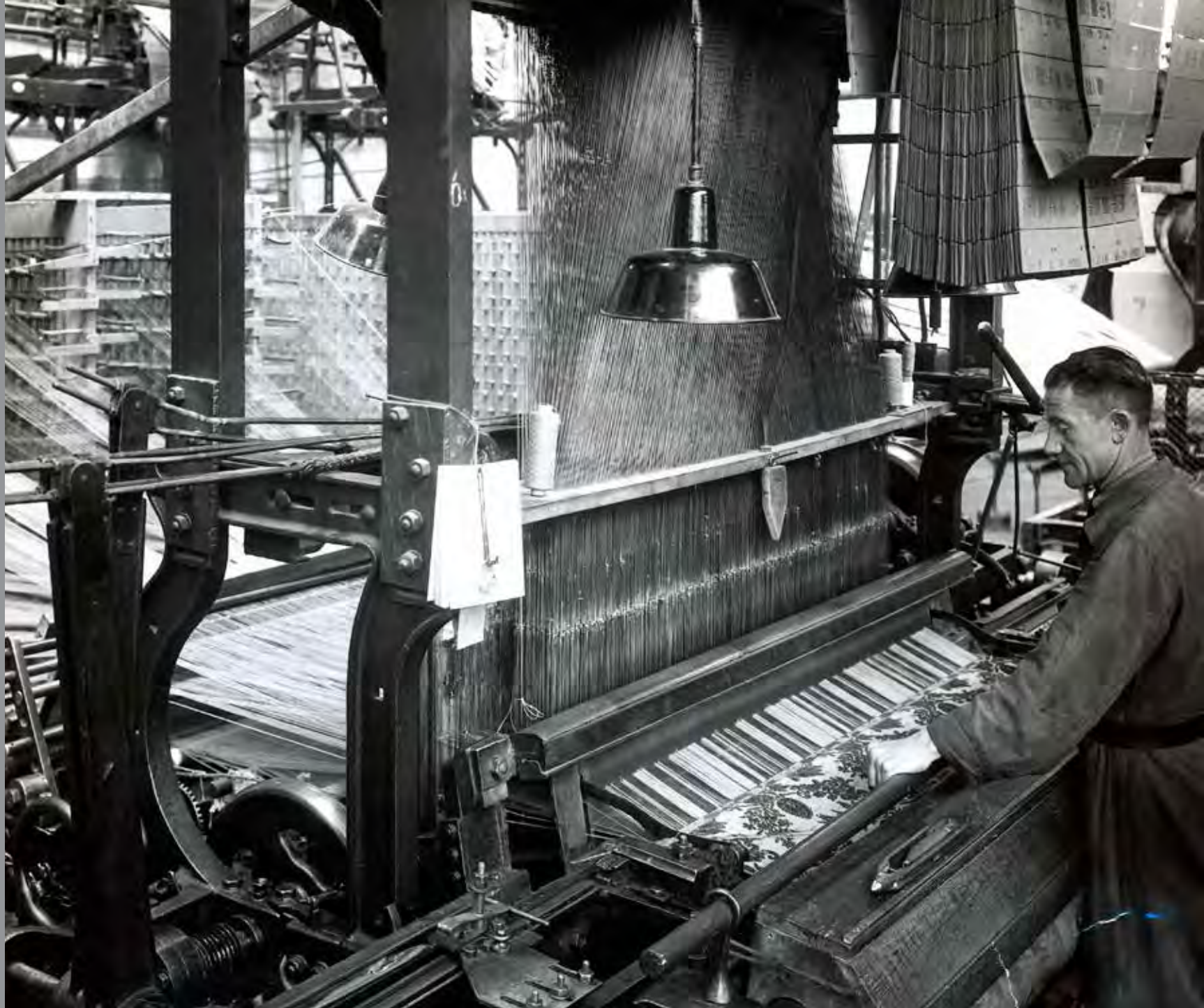
Het weven van gedessineerde stoffen op het Jacquard weefgetouw, linksboven zijn de ponskaarten zichtbaar
